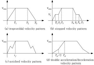
Fig. 11. Patterns of crane velocity (case (d) allows change in rope length)
